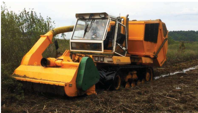
Figure 1. Photo : Exemple de broyeur avec exportation, adapté aux milieux forestier et humide. (Source SLAT)
