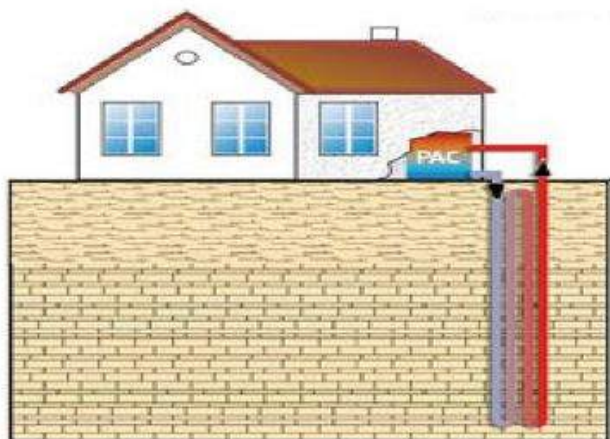
Sonde géothermique verticale
